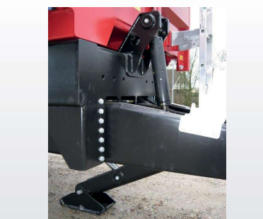
Justerbar træk. Hyd. affjedret træk kan eftermonteres.
