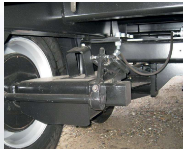
Vognen er monteret med bogie med bremses på begge aksler.
