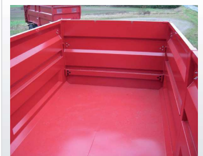
Kassen er opbygget med fuldsvejsede ladsider, profileret 45 graders overgang fra bund til sider.
