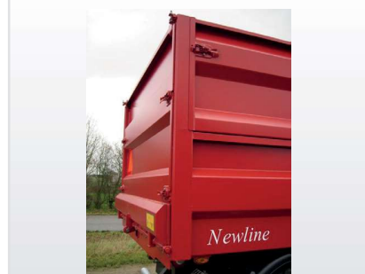
Hydraulisk bagsmæk med dobbelt virkende cylinder. Øverste bagsmæk tophængt.
