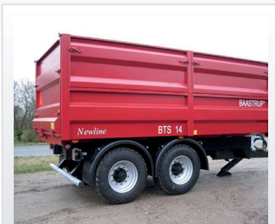
Aftagelige kornsider. Nederste del af kassen er 75 cm høj, kornsiderne er 85 cm høje.
