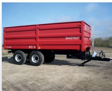
Kassen er opbygget med fuldsvejsede ladsider, profileret 45 graders overgang fra bund til sider. Hydraulisk støttefod.
