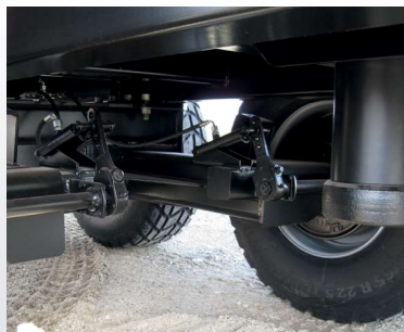
Vognen er monteret med bogie med brems på begge aksler.
