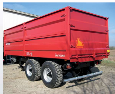
Hydraulisk bagsmæk med dobbelt virkende cylinder. Øverste bagsmæk top hængt. Lovpligtigt led lysanlæg er monteret.
