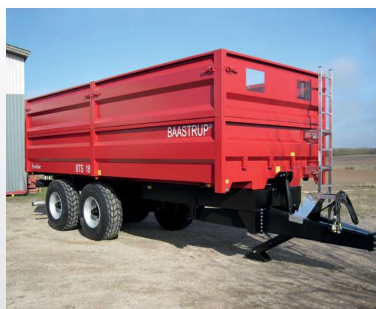
Aftagelige kornsider. Nederste del af kassen er 85 cm høj, kornsiderne er 75 cm høje.
